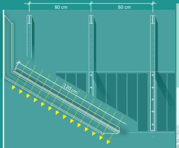
Über einem Südfenster verschönert die Solar-Markise die Fassade eines Gebäudes. Sie spendet Schatten in der Sommerzeit und erzeugt das ganze Jahr über Strom. Die lichtdurchlässigen Glas-Glas-Module sind an Winkeln aus feuerverzinktem Stahl befestigt. Auf Wunsch können die Winkel auch farblich eloxiert geliefert werden.
